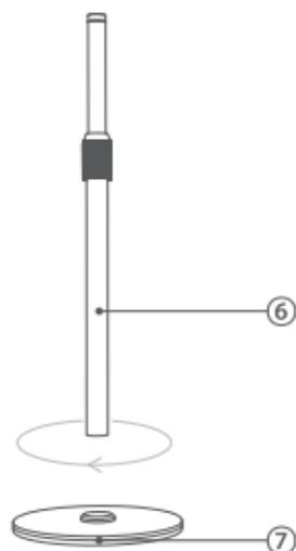
2- Coloque a rosca solta na haste por cima para então encaixar o anel de luz (1), e girando no sentido horário, rosqueie para prender o anel à haste (6).
