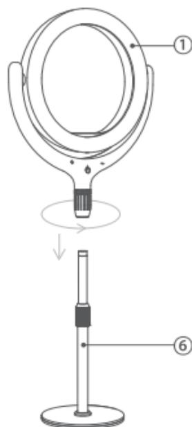
3- O Suporte para Smartphone (2) deve ser encaixado na haste metálica (3) , rosqueie a haste (3) na parte interna do anel de luz (1).
